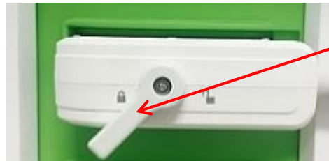
Figure 21 : Orientation du connecteur de la sonde
