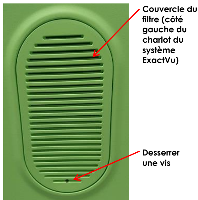
Figure 72 : Vue intérieure du panneau de gauche
